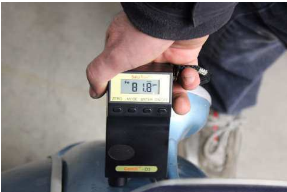
Original Lackierung, Lackschichtmessung am Rahmen hinten
