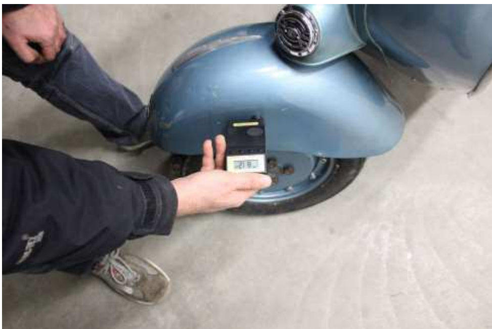
Original Lackierung, Lackschichtmessung am Kotflügel
