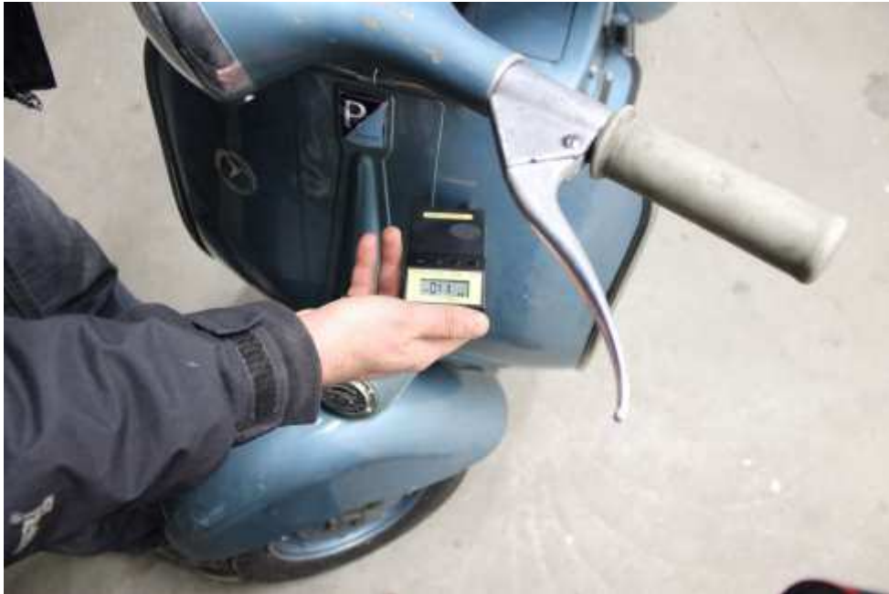
Original Lackierung, Lackschichtmessung am Beinschild
