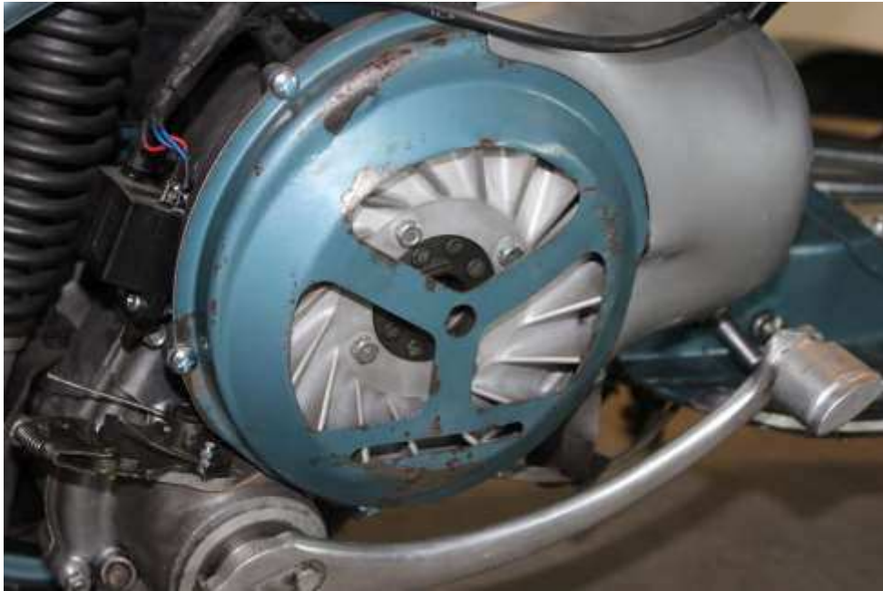
Zündanlage von Vespatronic inkl. Alu-Lüfterrad verbaut
