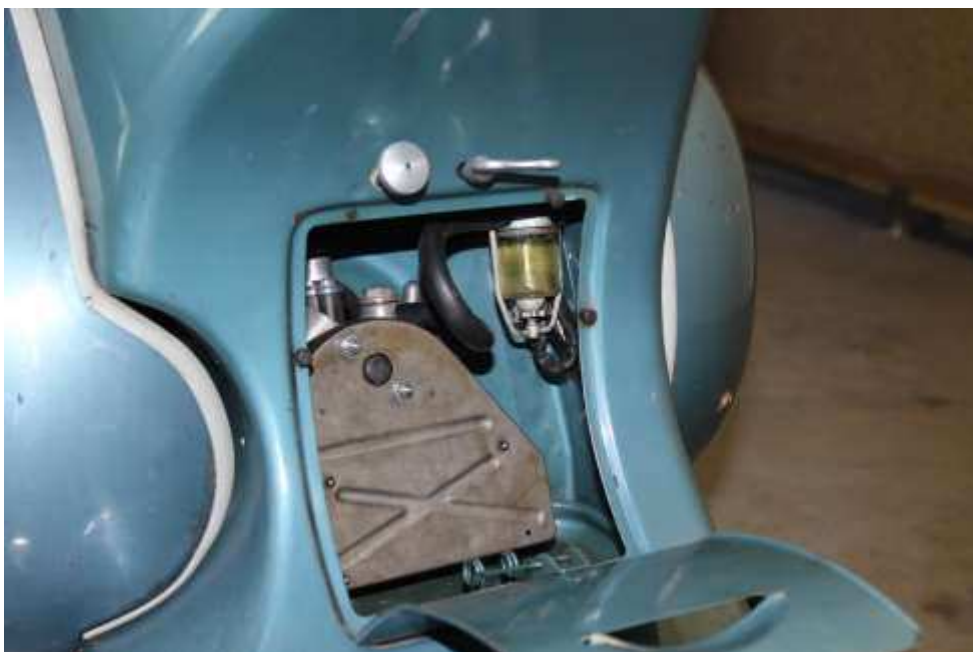
Original Vergaser sowie Benzinhahn
