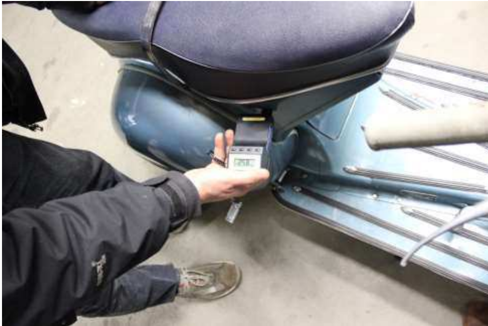
Original Lackierung, Lackschichtmessung am Rahmen rechts
