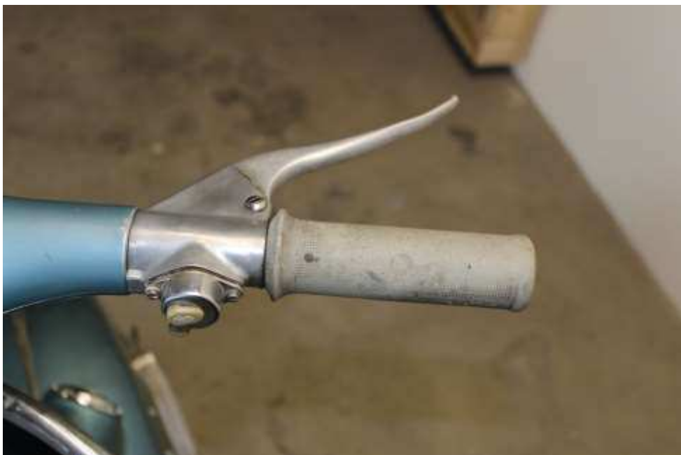
Original Armatur r. mit originalem Licht- u.Hupenschalter
