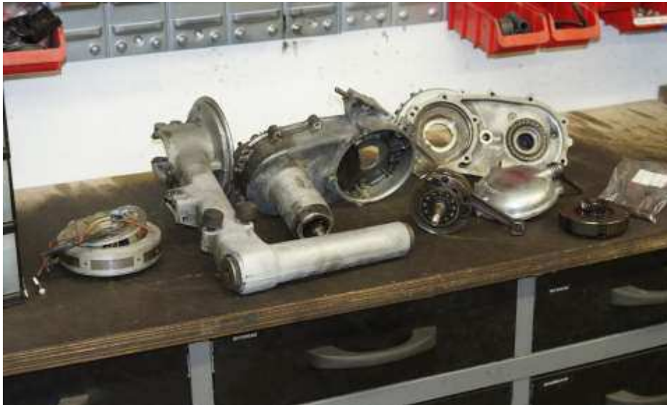
Motor zwecks Revision zerlegt
